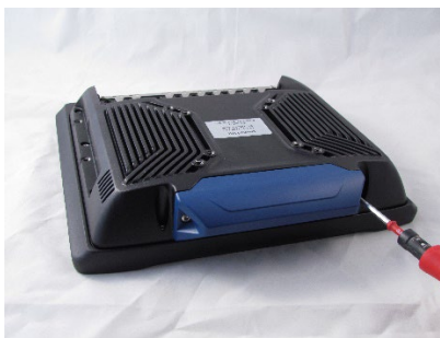
Fig. 15-9: Remove antenna cap
